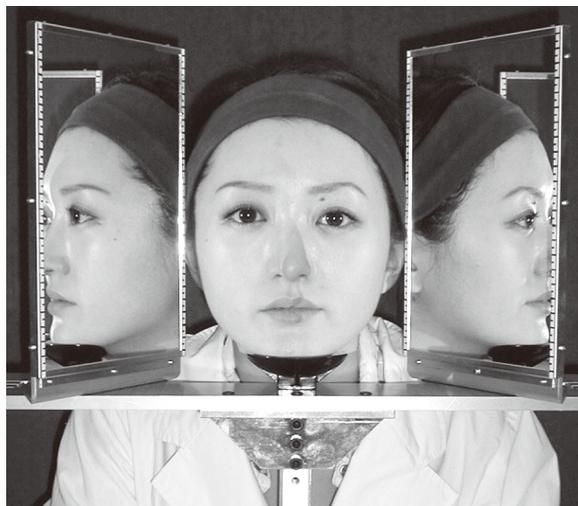
Fig. 3 表情運動時の正面顔画像と左右側面画像を同一画面内に融合するマルチビューシステム
